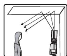
Для использования встроенной светоотражающей панели, необходимо одновременно выдвинуть из головки вспышки экран и широкую панель, а затем задвинуть панель обратно. Этот метод съемки сконцентрирует свет на глазах объекта, придав им блеск. Эта функция может достичь максимального эффекта, если головка вспышки направлена под углом 90 градусов.
