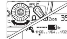
Мощность вспышки устанавливается тем же способом, как и в ручном режиме. Количество вспышек устанавливается от 1 до 100, частота – от 1 до 100.
