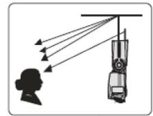
В этом методе съемки, головка вспышки направлена на стену или потолок, а для освещения объекта съемки используется отраженный свет для создания более естественного освещения. Если стена или потолок слишком удалены от объекта съемки, отраженного света может не хватить для необходимой экспозиции. Стена или потолок должны быть окрашены в белый цвет чтобы получить желательное отражение. Если отражаемая поверхность не белая, другой цвет может привести к нежелательным эффектам цветопередачи на фото.
